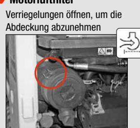
Außen- und Innenfilter entfernen
